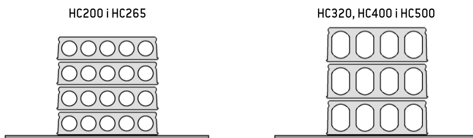
Rys. 27 – Schemat transportowy płyt HC w jednym stosie
