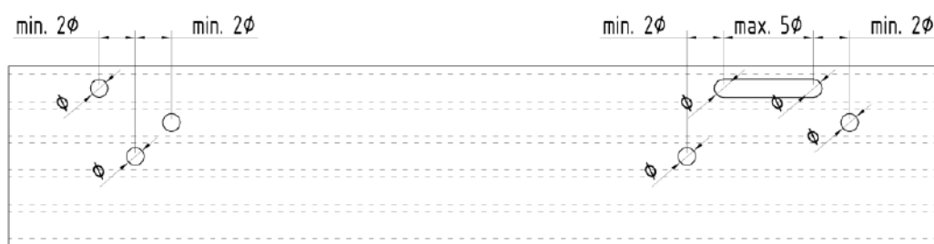
Rys. 14 - Zasady otworowania w płytach kanałowych
