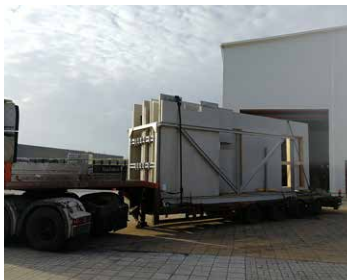
Kontener do przewozu prefabrykatów
