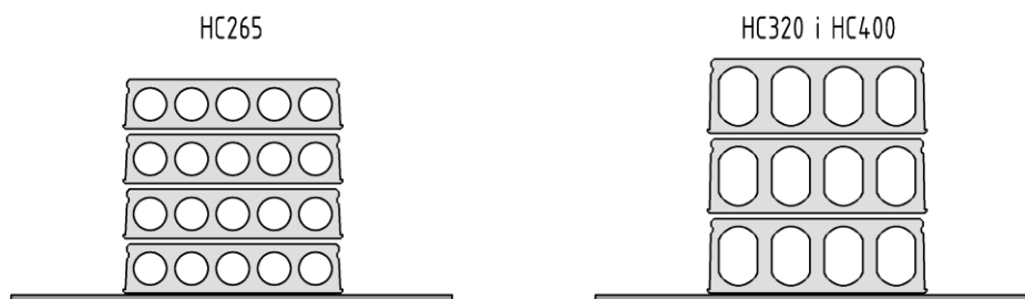
Rys. 22 – Schemat transportowy płyt HC w jednym stosie
