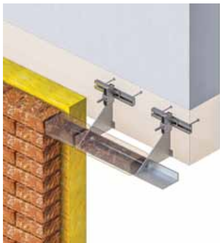
PRZYKŁAD ZASTOSOWANIA KONSOL Z CIĄGLYMI WSPORNIKAMI DO OPARCIA NADPROŻA Z WIDOCZNĄ KONSTRUKCJĄ WSPORCZĄ
