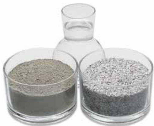
Główne składniki betonu: cement, woda i piasek.
