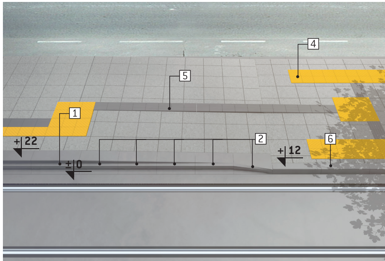
DETAL – UKŁAD KRAWĘŻNIKÓW PRZYSTANKOWYCH PRZEJŚCIOWYCH
